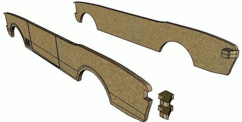
Junte as fatias numeradas começando pelo número "5" encaixando as peças "trava". Por ultimo coloque as peças laterais finais.
